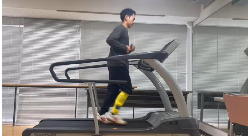
TUNE GRIDの活用に向けて加速度計を用いた実験の様子:歩行、ジョギング、ランニングの識別に向けた実験
